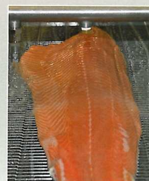
■ Après les opérations de salage, les saumons sont rincés via des buses qui diffusent de l'eau traitée à l'ozone. Ce lavage retire le sel, débactérise et permet d'allonger la DLC.
